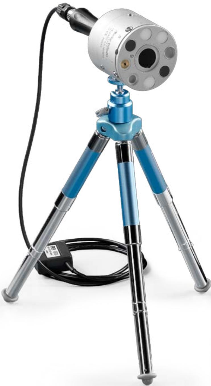
En utilisant le logiciel **DeltaLog13 de la version 1.0.1.0** et un PC, le **HD2402** peut être configuré (calendrier, date, heure, heure de début et la durée du enregistrement), et vous pouvez décharger et analyser des données enregistrées ou capturer les données en temps réel. Une fois configuré, l'appareil peut être déconnecté de PC et connecté à l'alimentation pour la capture et l'enregistrement des données en fonction des paramètres programmés.
