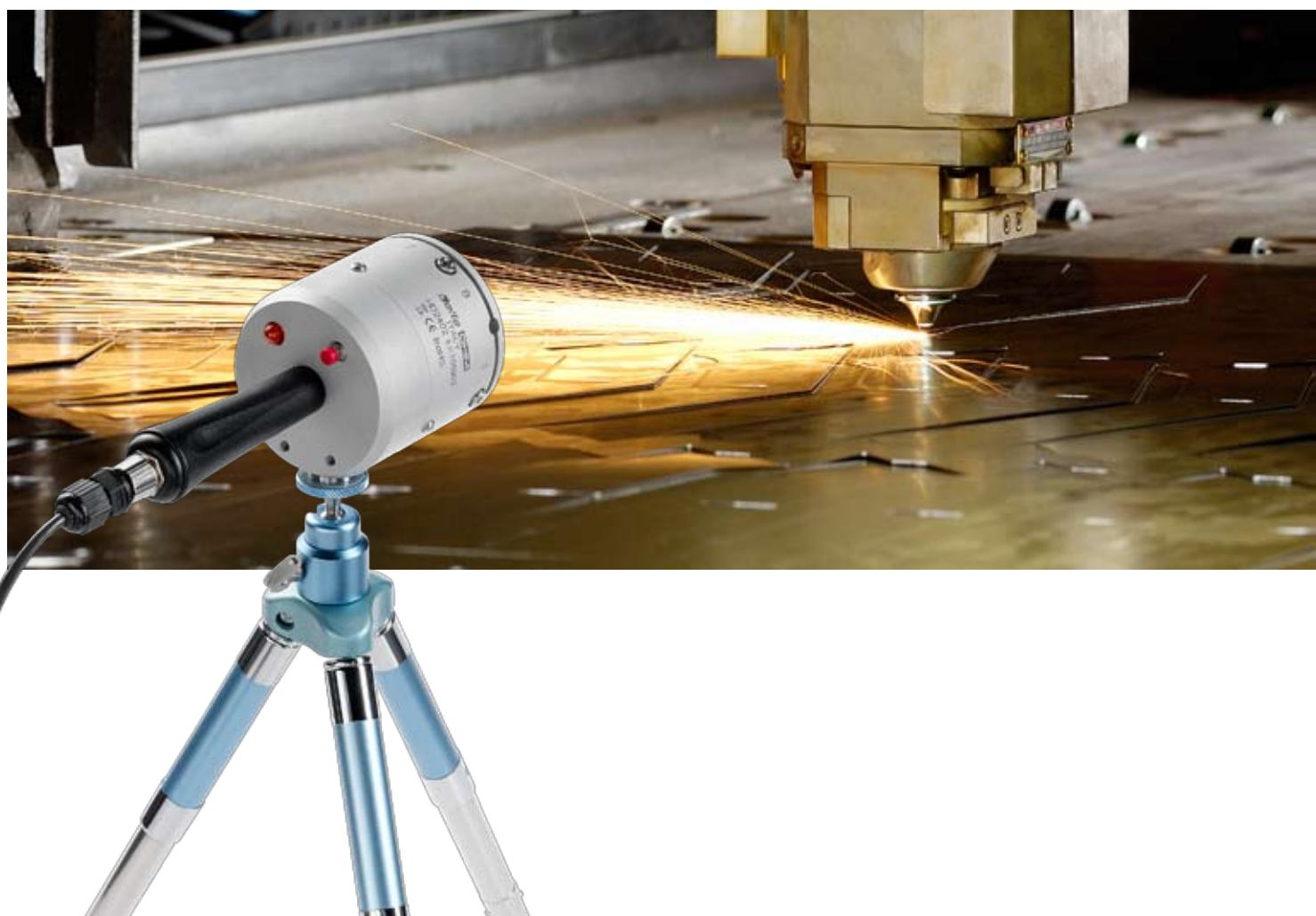
● **HD2402** ist ein tragbarer Foto-Radiometer-Datenlogger zur Messungen **nicht-kohärenter optischer Strahlung in Übereinstimmung mit der europäischen Richtlinie 2006/25/EG und der Gesetzesverordnung Nr. 81 vom 9. April 2008.**
