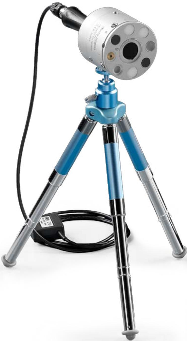
Mit der **Software DeltaLog13 ab Version 1.0.1.0** und einem PC kann das **HD2402** konfiguriert werden (Kalender, Datum, Uhrzeit, Start und Dauer der Speicherung) und die gespeicherten Daten heruntergeladen, analysiert oder aber Echtzeit-Daten übertragen werden. Sobald der Logger konfiguriert ist, kann er vom PC getrennt und zur Erfassung und Speicherung von Daten gemäß der programmierten Einstellungen mit der Stromversorgung verbunden werden.
